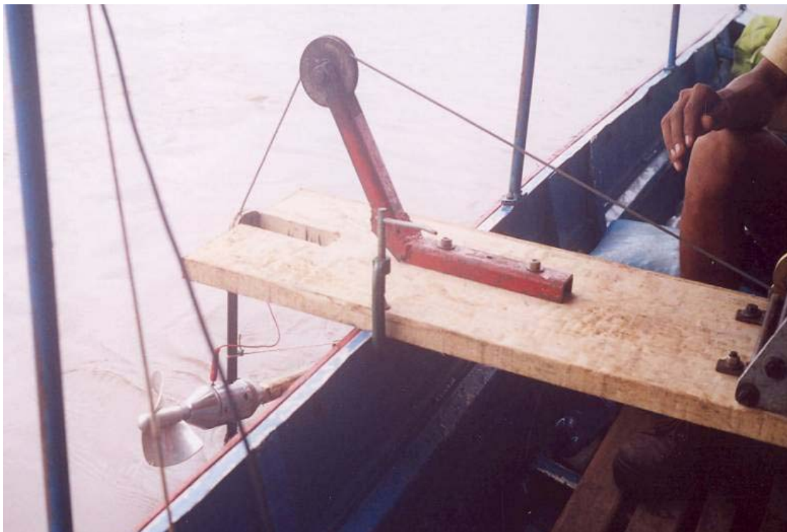
Gráfico 3.0: Medición de Velocidad de Corriente a Diferentes Profundidades con Correntómetro, para Aforo..
