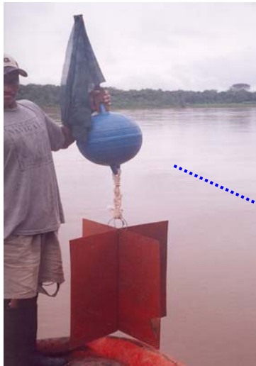
Gráfico3 .1: Medición de Velocidad Superficial y Líneas de Corriente.
