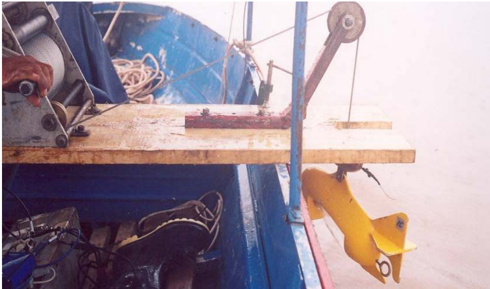
Gráfico 5.0: Muestreador Integrador de Material en Suspensión.
